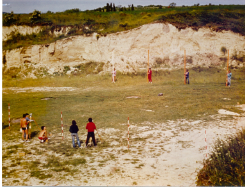
Geodézia mérőgyakorlatok során készült fotók egykor és most. Zsinórállás építése, derékszögű koordinátamérés és kitűzés, illetve területszintezés, területfelmérés során.
