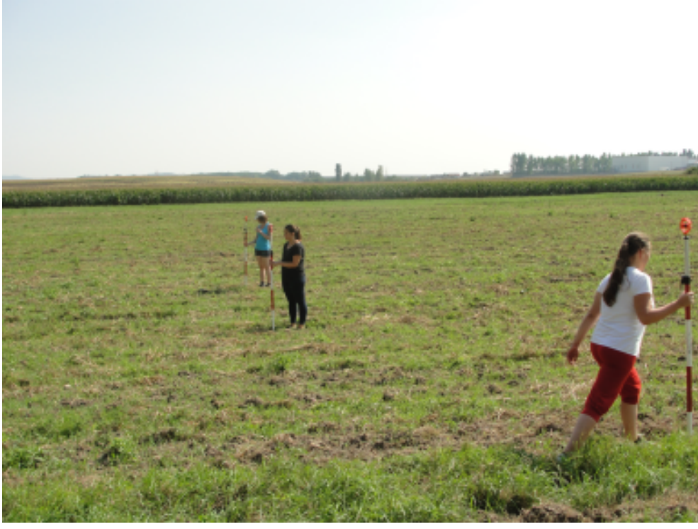
Geodézia mérőgyakorlatok során készült fotók egykor és most. Zsinórállás építése, derékszögű koordinátamérés és kitűzés, illetve területszintezés, területfelmérés során.
